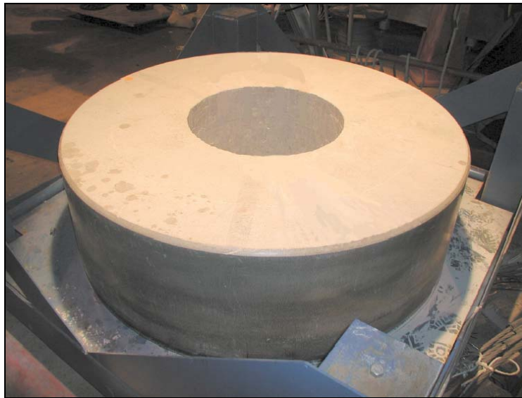
Figure 1.9 : Anneau de bentonite MX-80 compactée (Andra, 2005b). L'anneau possède un diamètre de 1.65 m.
