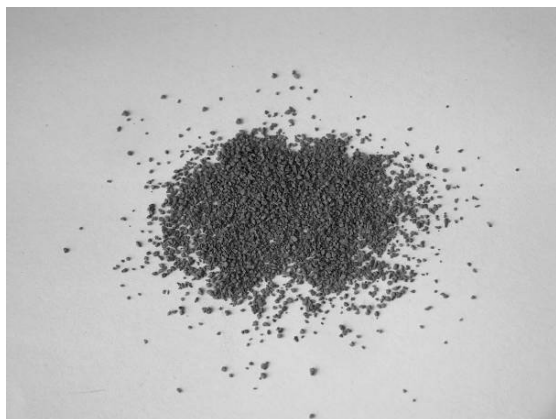
Figure 3.12. Image optique du support 250-400 \mu\text{m} ; 21 \text{m}^2/\text{g} obtenu après broyage et tamisage du support 250-400 \mu\text{m} ; 21 \text{m}^2/\text{g}
