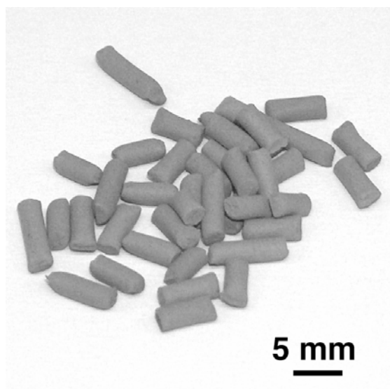
Figure 3.1. Image optique du carbure de silicium synthétisé selon la méthode à mémoire de forme (à l'échelle du laboratoire au CRV).
