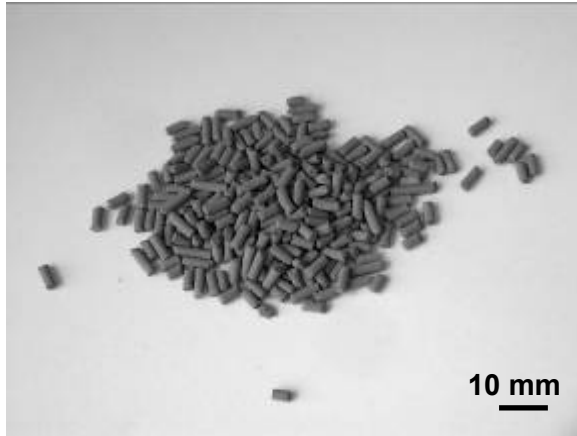
Figure 3.8. Image optique des extrudés 2/5mm ; 20m 2 /g.
