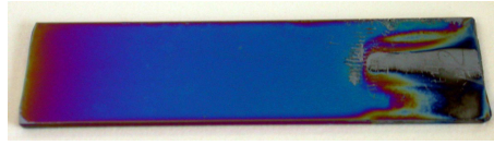
FIG. 3.12 – Forme des plaques de silicium utilisées pour la construction d’un film par nébulisation. Il s’agit ici d’un film de (PGA/PAH) 40 réalisé à l’aide du dispositif non automatique de nébulisation. La couleur est due à l’absorption de la lumière par le film.
