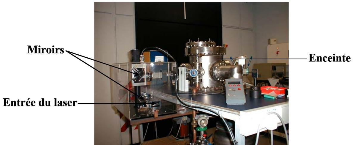
Fig. II.6 : Dispositif d'ablation laser (vue arrière).
