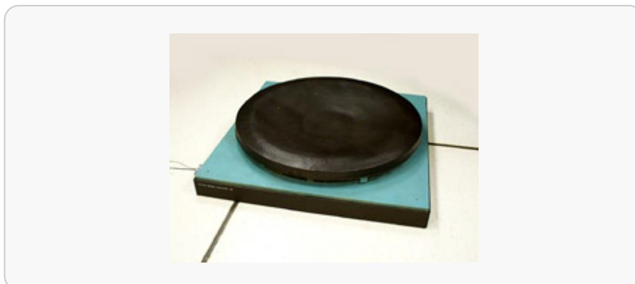
Fig. 2.7: Tapis à capteurs de poids *Virtual Motion Controller*, Hit Lab Washington.
