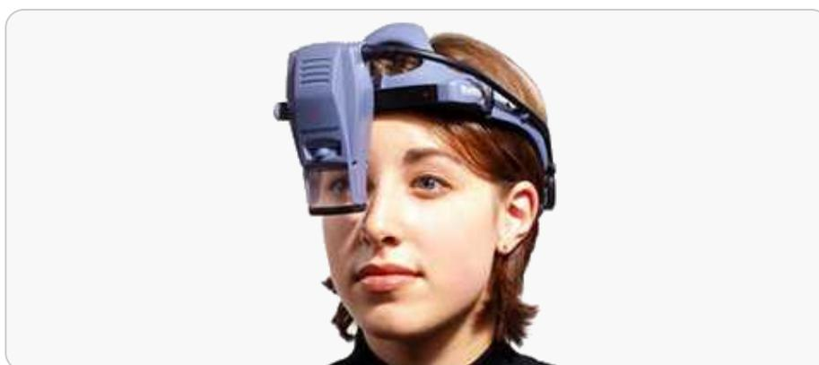
Fig. 3.5: Système d'affichage laser rétinien Nomad<sup>TM</sup> de Microvision.
