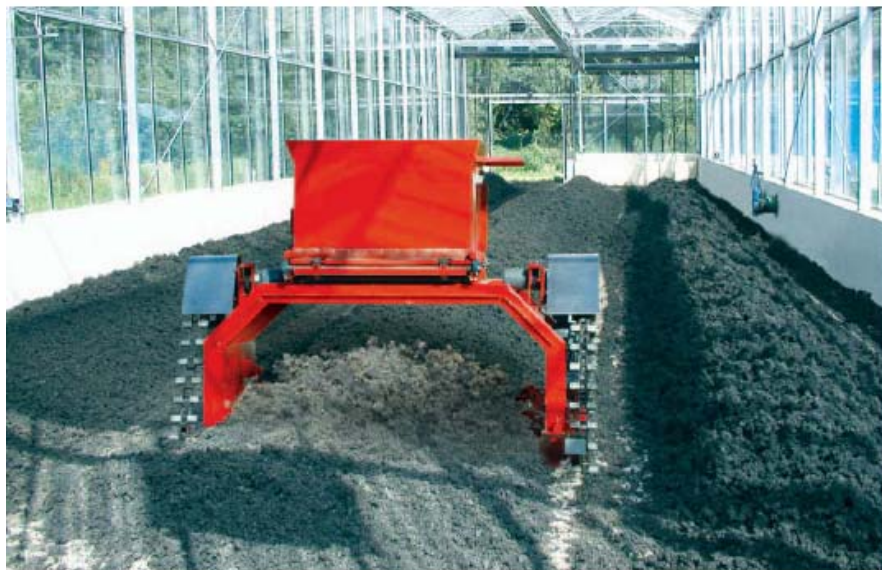
Figure I.14 Système de retournement du procédé Soliamix.
