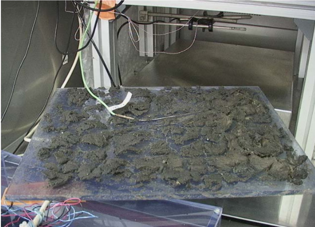
Figure annexe VII.2 Mise en évidence du retrait de la boue en fin de séchage
