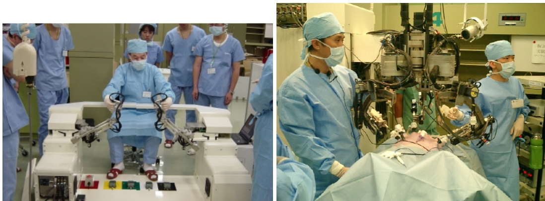
FIG. 2.17 – À gauche la console maître et à droite le manipulateur esclave du télémanipulateur de l'université de Tokyo.
