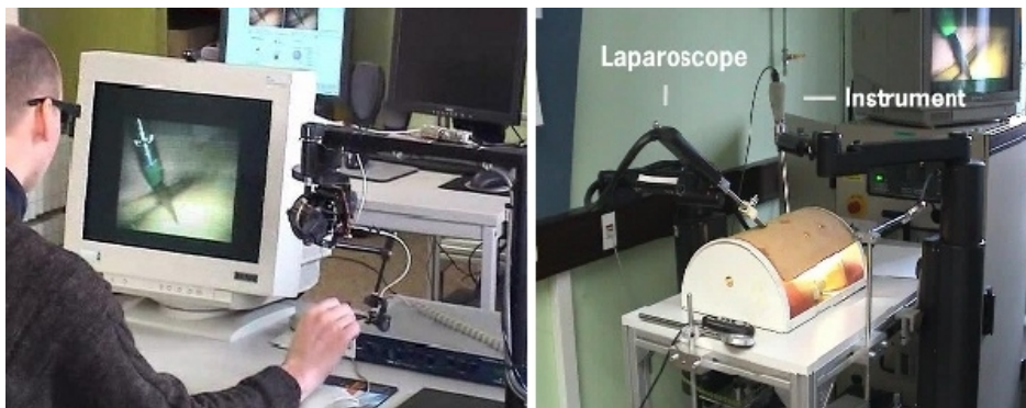
FIG. 2.16 – À gauche la console maître et à droite le manipulateur esclave du système maître-esclave du DLR destiné aux interventions mini-invasives.
