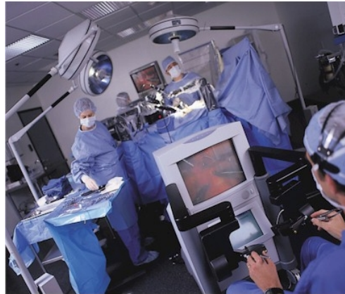
FIG. 2.12 – Système maître-esclave Zeus de Computer Motion
