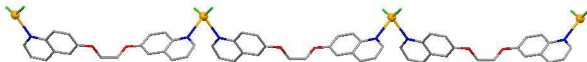
FIG. 2.22 – Représentation, selon l'axe cristallographique a , du réseau monodimensionnel de type escalier obtenu lors de l'auto-assemblage du tecton 10 et du chlorure de mercure.
