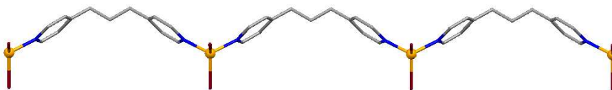
FIG. 42 – Représentation du fil moléculaire de type zig-zag obtenu par Cheal Kim et Ho Gyeom Jang par auto-assemblage de 1,3-bis(4-pyridyl)propane et d'iodure de zinc.
