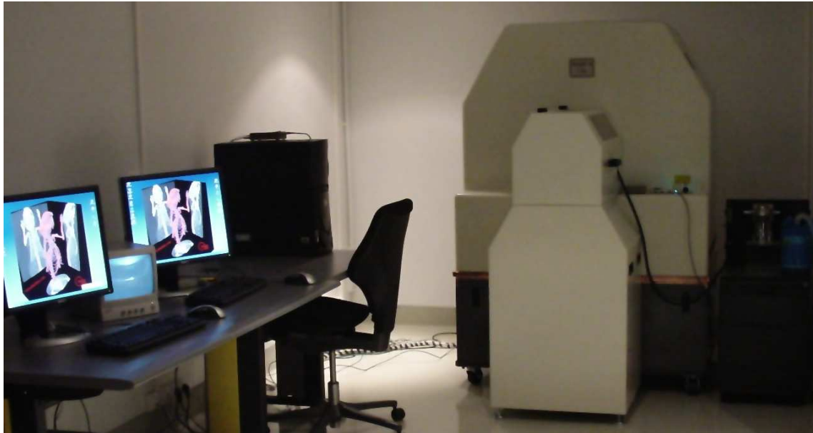
FIG. 8.4: Imageur pour petit animal : cette photo montre l'imageur scanner pour petit animal utilisé par l'Ircad.
