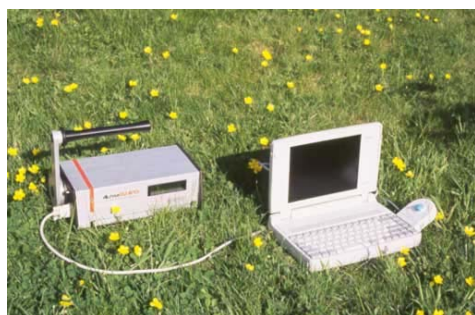
Figure 1-15 : La chambre d'ionisation Alphaguard.
