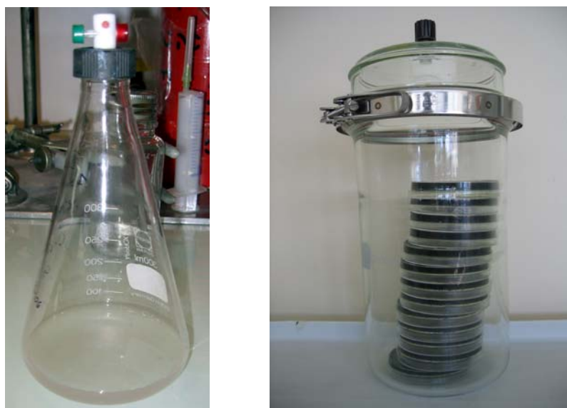
FIGURE M.1 - Flasque (A) et jarre de verre (B) utilisées pour la culture des bactéries du genre Methylobacterium en milieu confiné.
