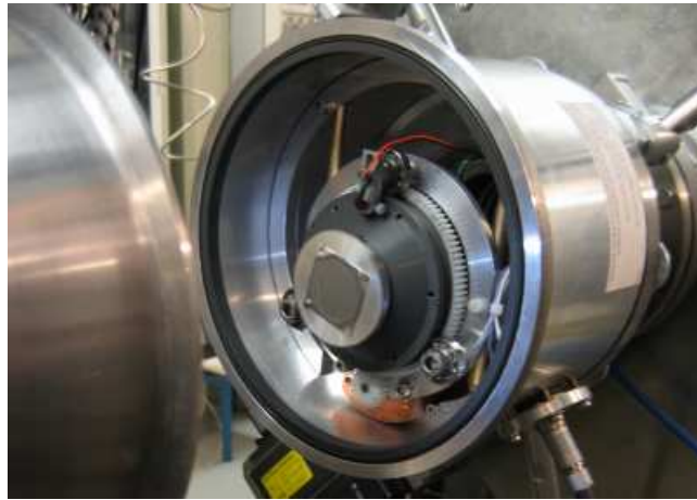
FIG. 10.7 – Vue de la cible rotative développée à l'IREs et montée à l'entrée de RITU
