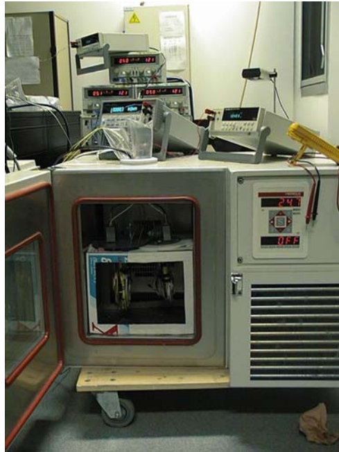
Figure 2.4 : Photo de la disposition des interféromètres de référence et des thermorésistances dans la chambre climatique.
