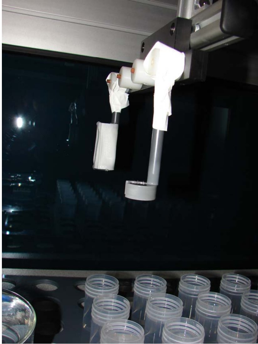
Figure 2.3.2e : Visualisation du système en place sur le dipping robot. En avant un portoir a été laissé vacant, au fond un segment de prothèse est fixé sur l'autre portoir, en bas, les bacs de trempage.
