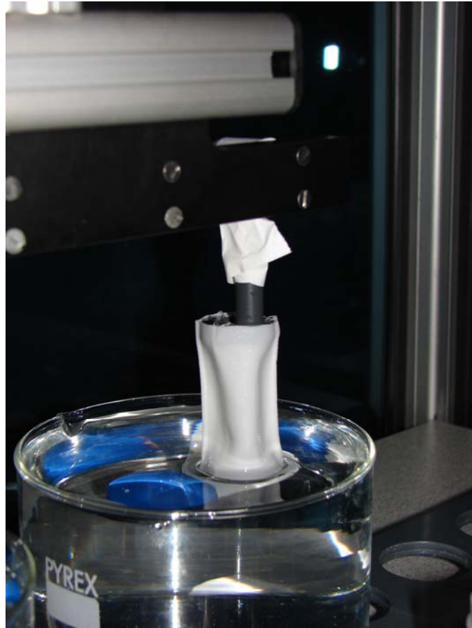
Figure 2.3.1a : Trempage par le dipping robot d'une prothèse fixée sur le portoir.
