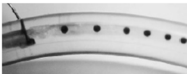
Figure 2.5.8. Photo d'un système microfluidique comprenant une aiguille dans un tube capillaire 94 .
