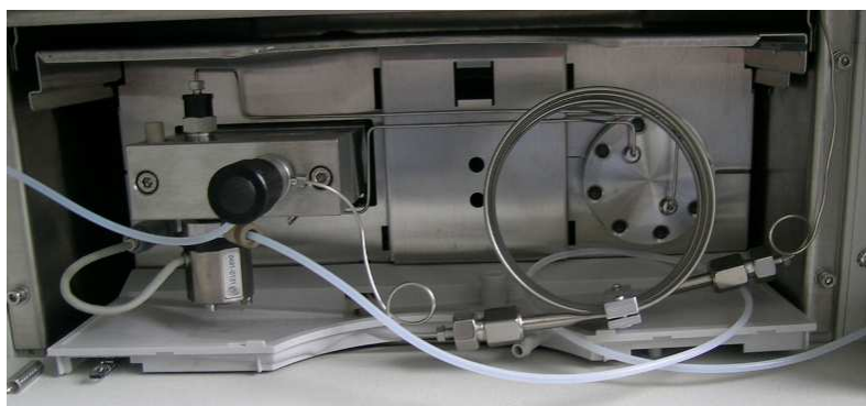
Figure 3.2.6. Pompe Agilent 1100 series placée sous le four.
