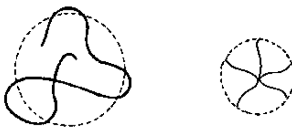
Figure 4.3.7. Rayons de giration pour des polymères linéaire (gauche) et branché (droite) de même masse molaire.
