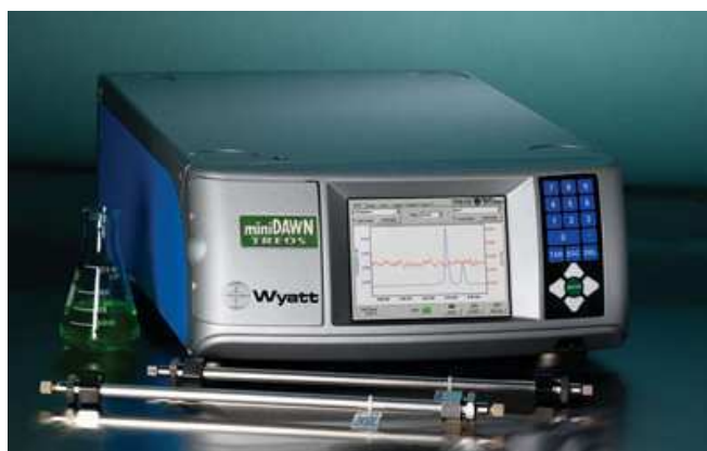
Figure 3.3.1. Détecteur à diffusion de la lumière 3 angles Minidawn Treos (Source : Wyatt Technologies).
