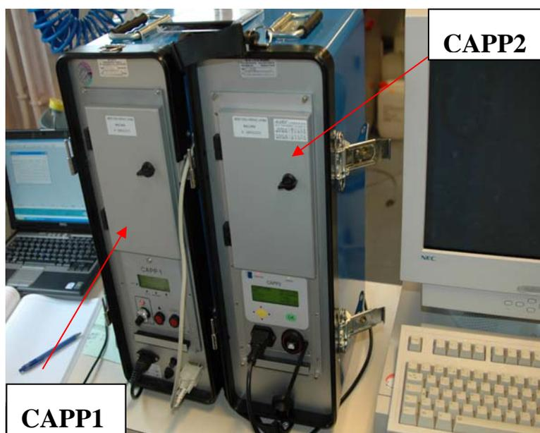
Pour pouvoir estimer l'incertitude sur les résultats donnés par les CAPP, on a déterminé leur rendement. Pour cela, on a placé sur les scintillateurs, placés sur les photomultiplicateurs, une source d'américium 241 scellée, dont on connaît l'activité. On obtient le rendement des CAPP à partir du rapport du nombre de désintégrations expérimental sur le nombre de désintégrations théoriques. Cette efficacité est déterminée à partir de l'activité des sources utilisées.
