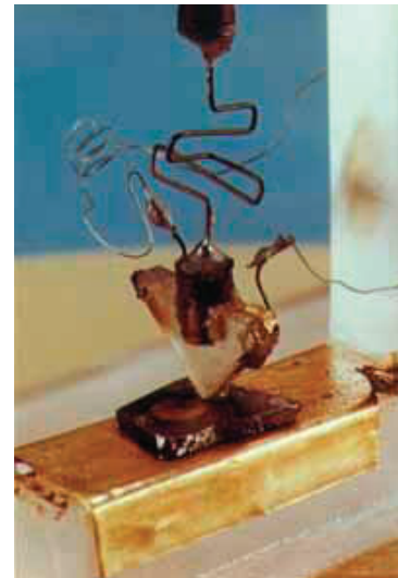
Fig. 2 : Une photo du premier transistor
