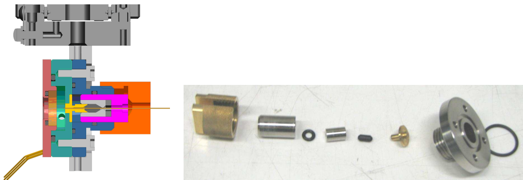
(a) Vue en coupe d'un réservoir et du dispositif de maintien de la fibre.
