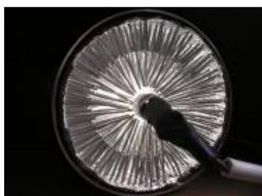
Figure 57. Exemple de réacteur de type « paillason ». Dans cet exemple, une alternance de deux tailles d'agrafes a été choisie pour améliorer l'illumination dans les zones éloignées de la lampe dans ce réacteur plus large que celui utilisé lors des tests de décontamination.
