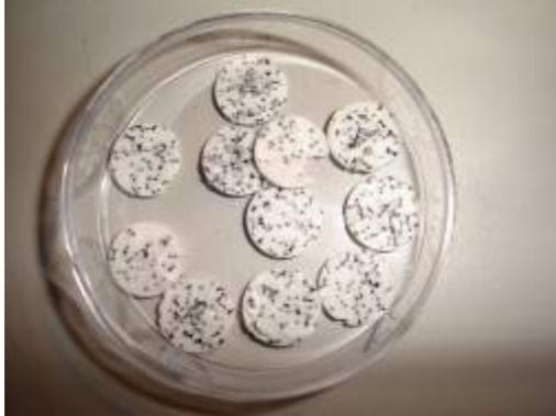
Figure 78. Coupes de mousse de PU incluses dans du silicone.
