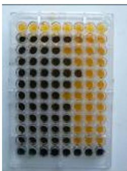
*Figure 14. Exemple de plaque « multipuits » utilisée pour réaliser des numérations par la méthode du nombre le plus probable. Les puits violacés indiquent une prolifération bactérienne au contraire des puits jaunes. Détails dans la partie expérimentale ou dans (Josset, Keller et al. 2008).*
