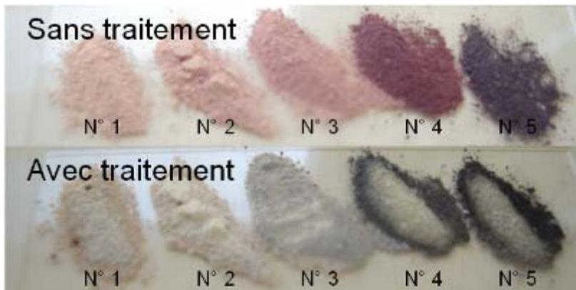
Figure 25. Changement de couleur dû au posttraitement thermique pour les 5 échantillons (h. sans traitement, b. après traitement). Le noircissement se produit dès l'illumination de  $\text{Ag}/\text{TiO}_2$ , du fait des propriétés photochromiques de ces solides (Ohko, Tatsuma et al. 2003).
