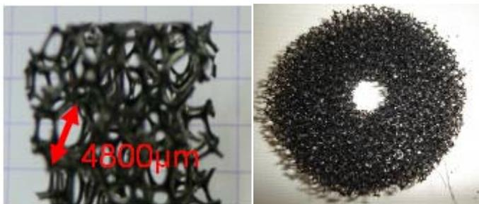
Figure 33. (g.) Structure de la mousse de PU (taille moyenne des alvéoles  $\geq 4800 \mu\text{m}$ ). (d.) Anneau en mousse de PU composant le réacteur (70mm-20mm).
