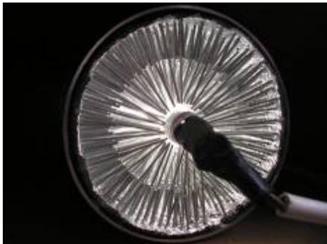
Figure 29. Exemple de réacteur de type paillason. Dans cet exemple, une alternance de deux tailles d'agrafes a été choisie pour optimiser l'illumination dans les zones éloignées de la lampe dans ce réacteur plus large que celui utilisé lors des tests de décontamination.
