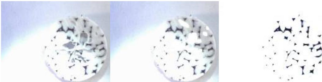
Figure 79. (g.) Coupe de l'inclusion de mousse de PU dans du silicone, magnifiée 10x. (m.) Les bulles sont retouchées et le contraste augmenté (d.). On obtient alors une image en noir et blanc sur laquelle les mesures d'aires et de périmètres peuvent être réalisées.
