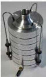
Figure 19. Impacteur d'Andersen à 6 étages. L'air est aspiré par l'orifice situé en haut à un débit précis de 28,3 L/min grâce à une pompe à vide. À chaque étage est disposée une boîte de Pétri sur laquelle les particules de tailles suffisantes vont s'impacter par inertie. Les particules plus petites continuent leurs trajets, entraînées par le flux.
