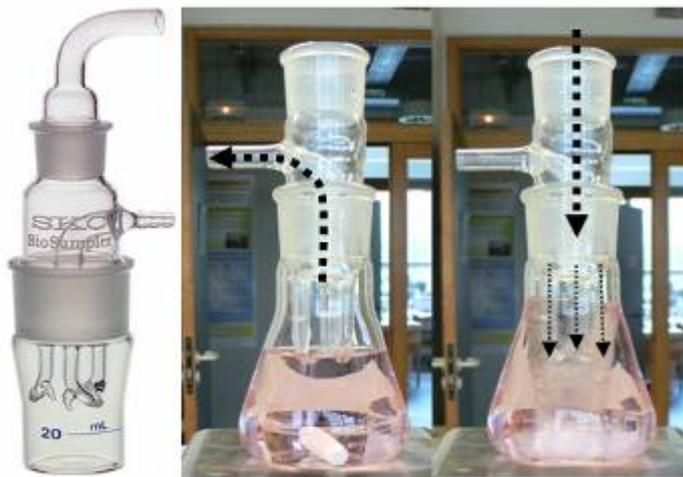
Figure 37. (g.) Système breveté de récupération BioSampler. (m.) Système développé au laboratoire s'inspirant du BioSampler et permettant d'aspirer le flux d'air à analyser vers une pompe à vide. (d.) Celui-ci entre par le haut du système avant d'être séparé en trois flux accélérés par rétrécissement des orifices de sortie des buses de sorte que les microorganismes s'impactent dans le vortex liquide créé par l'agitation magnétique.
