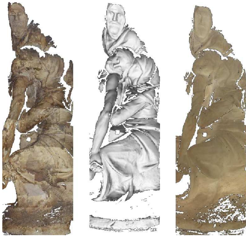
Figure 5.10 – Gauche : texture diffuse obtenue par un assemblage naïf de photographies. Milieu et droite : textures de normales et de coefficients de réflexion diffuse extraites par la méthode de Rushmeier et al. [154].
