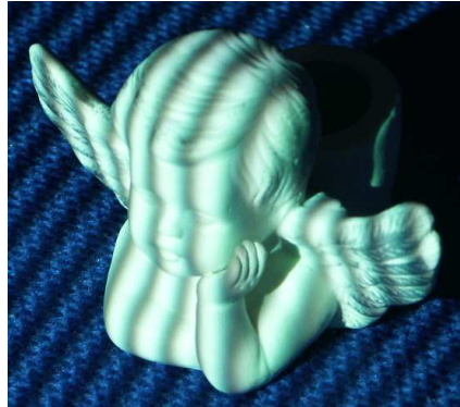
Figure 6.3 — Franges lumineuses projetées par le scanner pour la mesure de formes. La variation d'intensité des franges est décrite par une courbe sinusoïdale en niveaux de gris, permettant d'identifier chaque frange de manière unique grâce à un calcul de la phase de cette sinusoïde en chaque pixel de la caméra d'acquisition.
