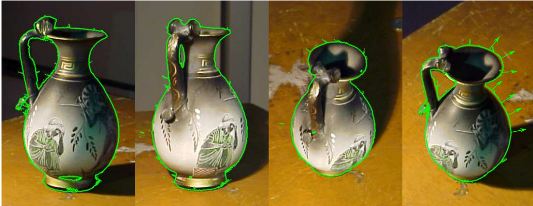
Figure 6.20 – Estimation visuelle de la qualité du calibrage caméra, par comparaison de la silhouette projetée de l'objet 3D dans l'espace image par rapport à son contour dans la photographie. Données obtenues par la numérisation du vase grec.
