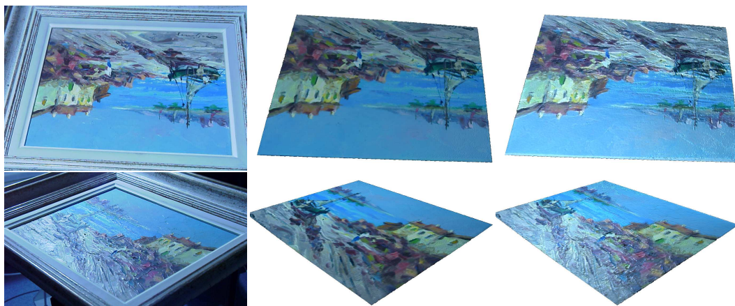
Figure 9.7 — Gauche : photographies du tableau test. Milieu : rendu par plaquage de texture classique sur un simple plan. Droite : rendu à l'aide d'une texture bidirectionnelle et de notre méthode hybride.
