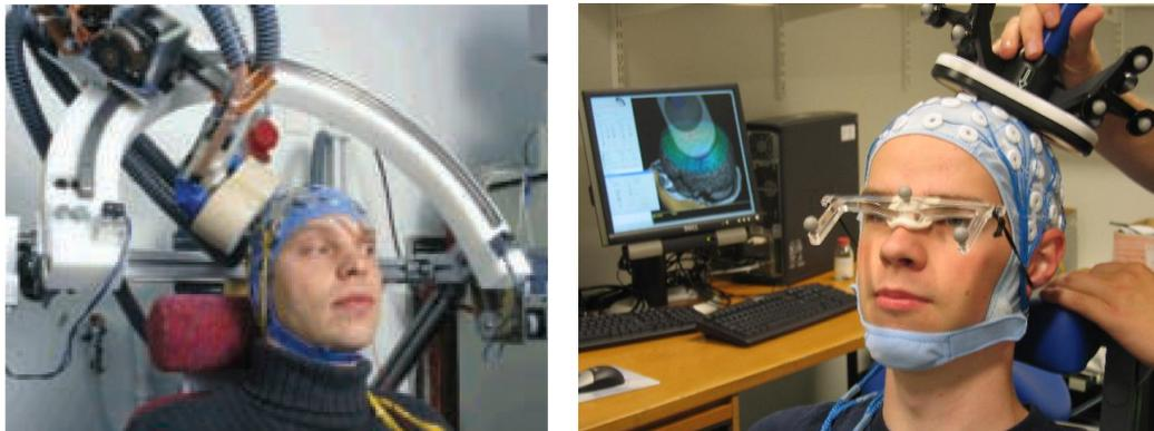
FIG. 1.27 – SMT assistée par ordinateur au laboratoire BioMag. Prototype initialement développé puis abandonné à gauche, système commercial manuel actuellement utilisé à droite.
