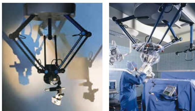
FIG. 2.10 – Robot SurgiScope<sup>®</sup> utilisé en neurochirurgie comme porte microscope. Photos © ISIS-Robotics.
