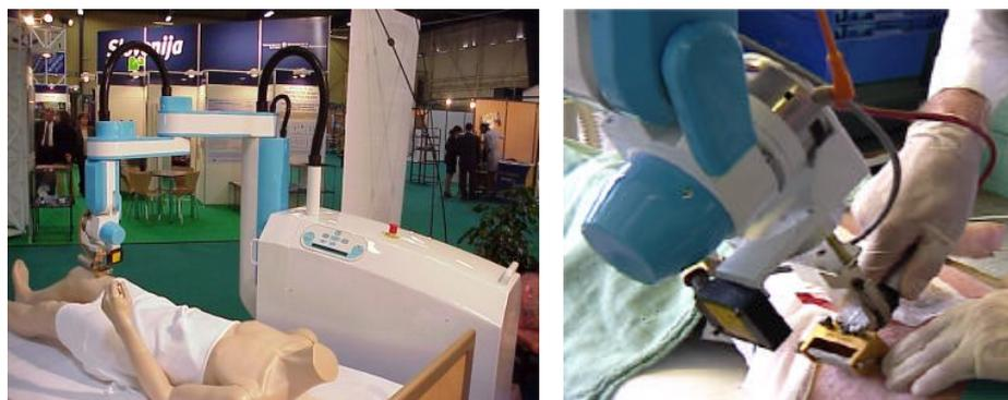
FIG. 2.9 – Robot Dermarob<sup>TM</sup> utilisé pour le prélèvement cutané. Photos © Sinters.
