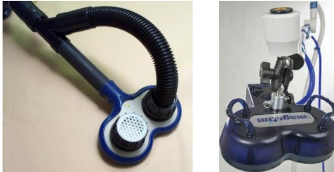
FIG. 1.22 – Sondes constituées de deux bobines de 70 mm et équipées d'un système de refroidissement qui aspire l'air à travers la surface de la bobine et emmène ainsi l'air chaud à l'extérieur du boîtier. A gauche, le système de refroidissement est déporté et l'air circule via le tube flexible, à droite un ventilateur est directement intégré au boîtier. Photos © Magstim Company Ltd.
