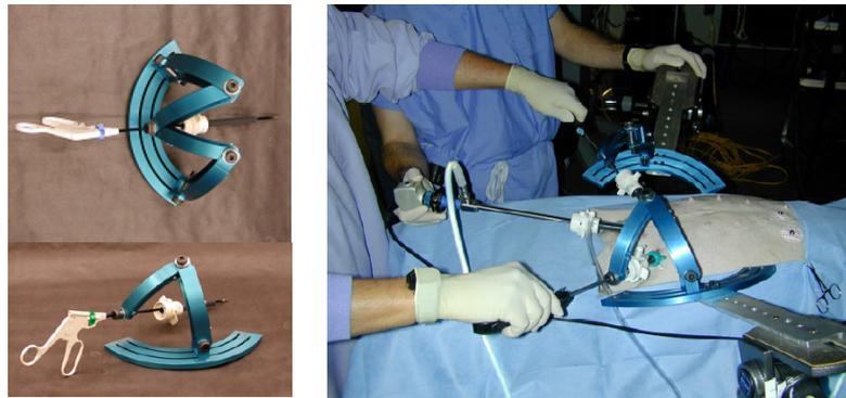
FIG. 2.18 – Porte outil sphérique pour la chirurgie mini-invasive dont la longueur des segments a été optimisée pour la tâche à réaliser [Lum04].
