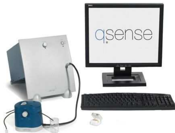
Figure II.12: Dispositif de QCM-D Q-sense type D300. Il comporte de gauche à droite : une chambre de mesure, une unité électronique pour contrôler la température des liquides dans la chambre via un système Peltier, et un ordinateur pour collecter les mesures puis les interpréter.
