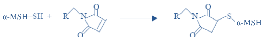
Figure II.6: Réaction de couplage entre les groupements thiol et maléimide. R = PGA
