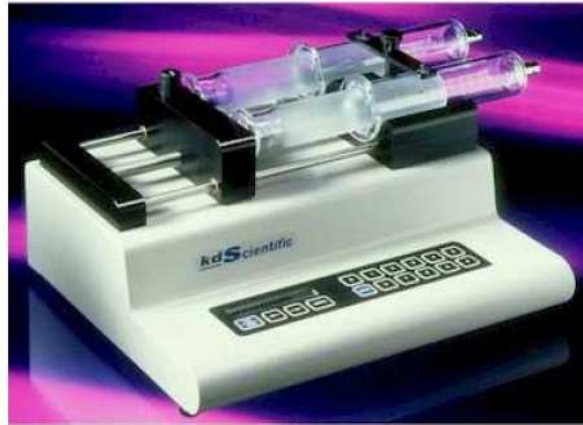
Figure II.9: Pousse-seringue KD Scientific 200. Ce pousse-seringue permet de délivrer un volume précis au nébuliseur via un tube en téflon de 2 mm de diamètre.
