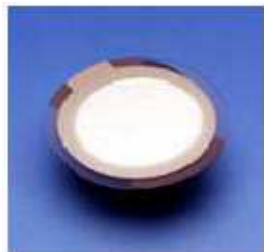
Figure II.15: Cristal de quartz vu de face. Le cristal de quartz est pris en sandwich avec de l'or et recouvert de \text{SiO}_2 sur la face de travail.
