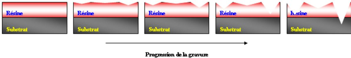
Figure III.13 : Transfert de la rugosité depuis la résine dans le substrat lors de l'étape de gravure
