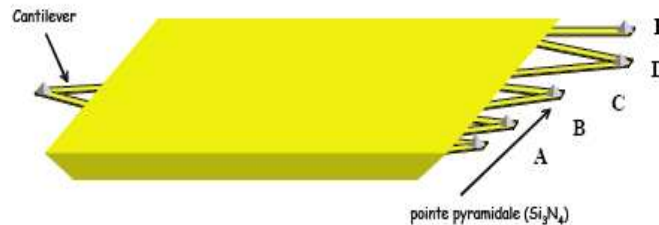
Figure 2.11. Schéma d'un support de cantilevers à pointes pyramidales de constantes de raideur différentes (Modèle MSCT-AUHW, Veeco). Généralement, seuls les cantilevers C et D sont utilisés pour l'imagerie.
