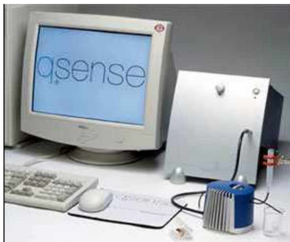
Figure 2.13. Photographie de l'appareillage de QCM-D comprenant une chambre de mesure thermostatée et une unité électronique interfacée à un ordinateur.
