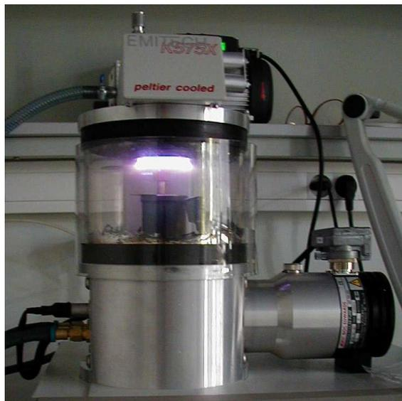
**Fig. 2.1** – Pulvérisateur Emitech K575X en cours d'utilisation. Nous pouvons distinguer clairement sous la cible le halo lumineux correspondant au plasma.
