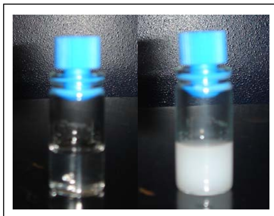
Figure 75. Solution aqueuse du polymère P(G 1 bis-OE 3 ) à 3 g.L -1 à une température inférieure (gauche) et une température supérieure (droite) à la température de démixtion.
