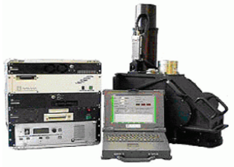
Figure 1.1. Système de scanneur laser ALS 40 (Ramirez, 2003) ; http://ciberhabitat.gob.mx/gobierno/lidar/
