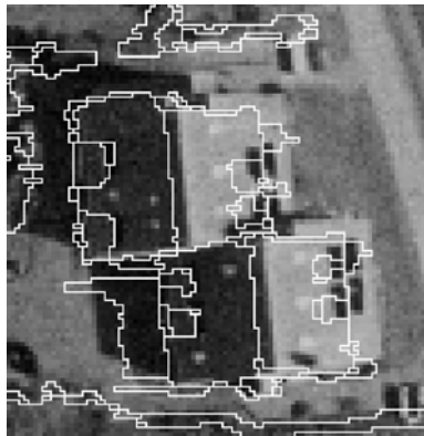
Figure 4.7. Extraction du contour et des lignes de rupture du bâtiment à partir du MNS (Haala et Brenner, 1997)
