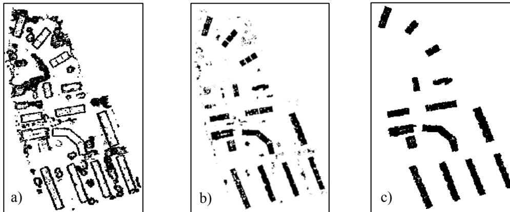
Figure 3.16. Élimination des points de végétation et des contours des bâtiments. a) Visualisation de la matrice topologie_plans ; b) Sursol après avoir éliminé les points parasites, il reste les points de végétation et de contours de bâtiments ; c) Masque des noyaux de bâtiments
