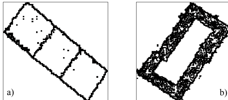
Figure 4.8. Détection des lignes des ruptures du toit de bâtiment à partir du MNS. a) Détection convenable des lignes de rupture ; b) Cas d'échec de la détection des lignes de rupture
