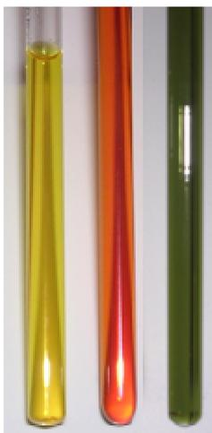
Figure VI, 50 : Propriétés optiques des complexes métalliques et des complexes d'inclusion. Solution de **Pb.43b** (gauche), mélange équimolaire de pyrène avec **Pb.43b** (milieu), mélange équimolaire de 9,10-diméthylantracène avec **Pb.43b** (droite).
