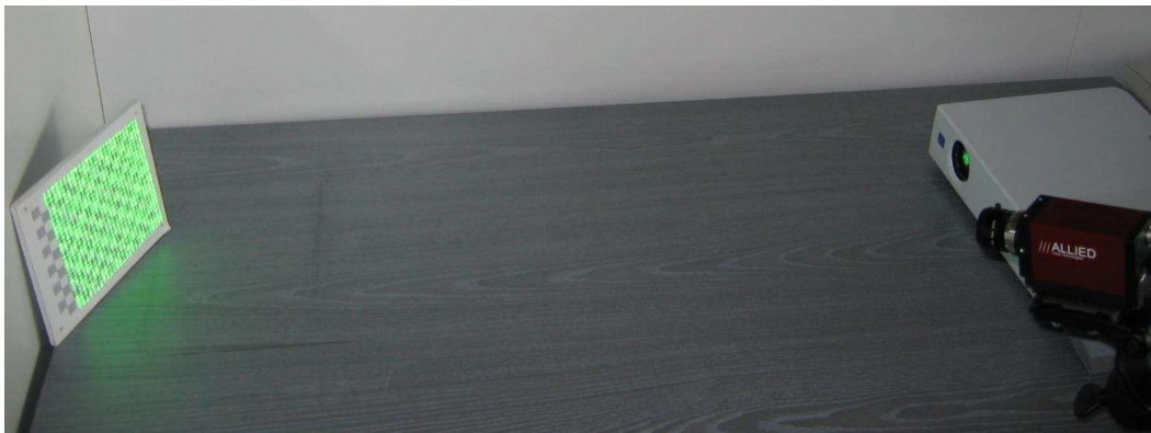
FIGURE 5.1 – Système de lumière structurée traditionnel projetant notre motif.
