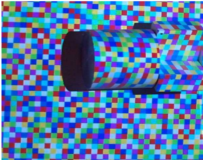
FIGURE 3.9 – Projection du motif encodé par des couleurs sur des objets étalons (source : [Chen03]).
