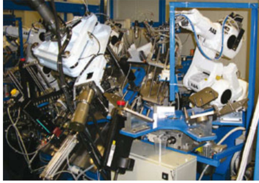
FIG. 3.11 : Photo de l'automate BAM ( Brick Assembling Machine ) chargé de l'empilement successif de feuilles de plomb et d'émulsions photographiques.
