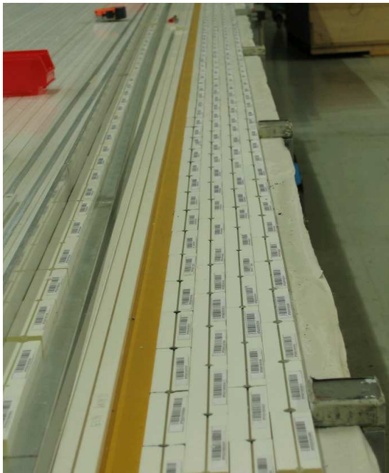
FIG. 4.44 : Assemblage des morceaux de scintillateur sur la partie adhésive de la tôle en aluminium en suivant un guide représenté par un barreau entier de scintillateur.
