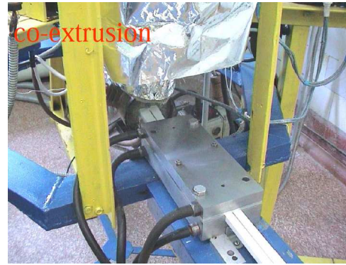
FIG. 4.2 : Co-extrusion d'un barreau de scintillateur utilisé dans OPERA. Fabrication, couche de \text{TiO}_2 et gorges des fibres WLS sont réalisées dans le même temps.
