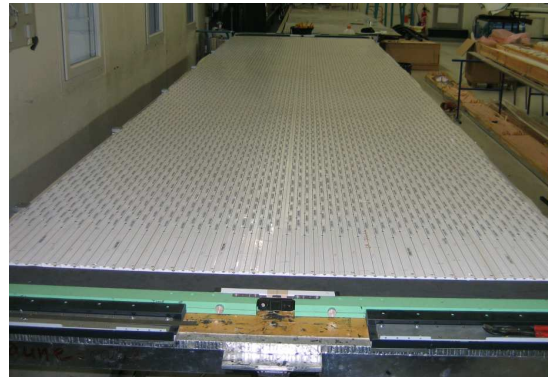
FIG. 4.45 : DOMINO une fois tous les morceaux de scintillateur assemblés et étiquetés avec un code barre pour la traçabilité.
