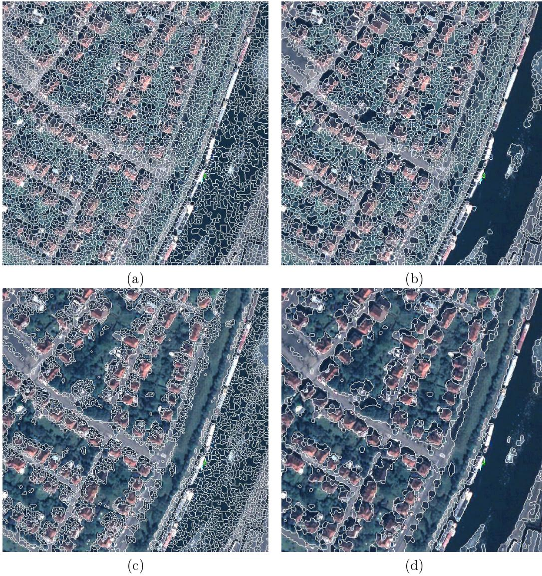
FIG. 3.12 – Segmentations obtenues par une ligne de partage des eaux avec pour paramètres des valeurs nulles (a), ligne de partage des eaux avec apprentissage de paramètres (b), ligne de partage des eaux avec transformation d'espace (c) et enfin combinaison de l'apprentissage des paramètres et transformation d'espace.
