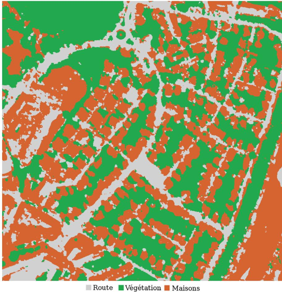
FIG. 4.5 – Classification du jeu d'évaluation utilisant la méthode des 3-ppv avec la méthode de génération des exemples fusion.
