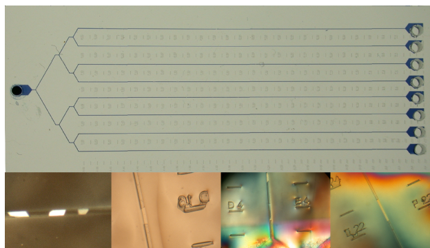
FIG. 2.13: Prototype en COC réalisé par matriçage à chaud. Les annotations ajoutées le long des canaux facilitent le repérage, le suivi de la croissance des cristaux et leur alignement dans le faisceau de rayons X. Le remplissage des canaux par une solution alcoolique colorée montre que le volume mort en haut de l'arborescence a été réduit. Les essais de cristallisation ont été fructueux dans cette puce, avec des cristaux de thaumatococcus dont certains remplissent les canaux sur 500 \mu\text{m} (en bas à droite).
