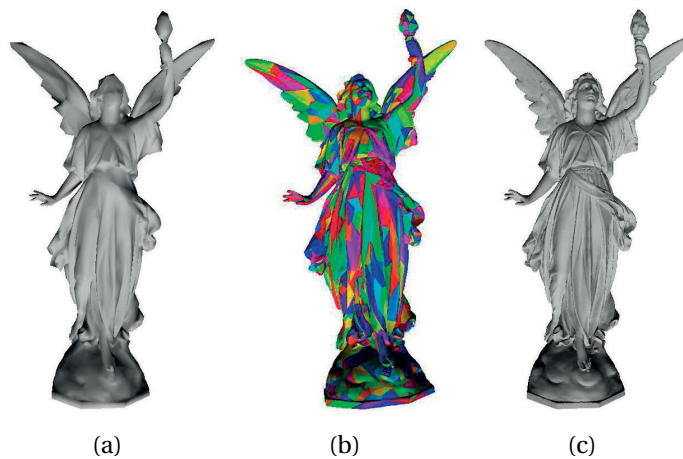
FIGURE 4.14 – La méthode des displacement patches . Le modèle 3D Lucy (116 Millions de triangles). (a) représentation grossière. (b) Découpage du modèle grossier en patches. (c) Le modèle raffiné (64 fps). (images de [96])
