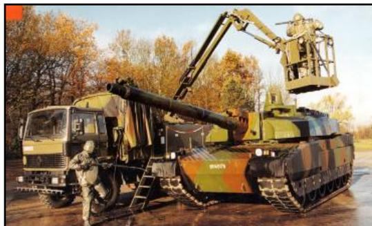
*Figure 7: Système de décontamination approfondie (SDA) en action lors d'un exercice de décontamination d'un char Leclerc.*
