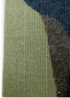
*Figure 113 : Aspect visuel d'un textile après 5 couches successives de TiNT-WO<sub>3</sub> 4% déposées par vaporisation par la méthode LbL sur un échantillon de textile.*
