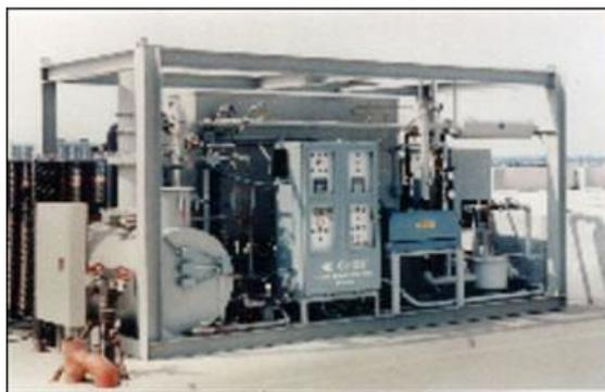
**Figure 4:** le système CATOX (catalytic oxidation) est un système de traitement des flux d'air contaminé par oxydation catalytique breveté par Honeywell<sup>®</sup>.
