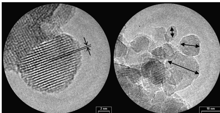
**Figure 34 :** MET à haute résolution (gauche) de l'échantillon  $\text{TiO}_2$  anatase/rutile (50:50) utilisant le Brij56 comme structurant. Exemple d'une particule d'anatase (gauche) et d'un mélange de phases anatase/rutile (droite).
