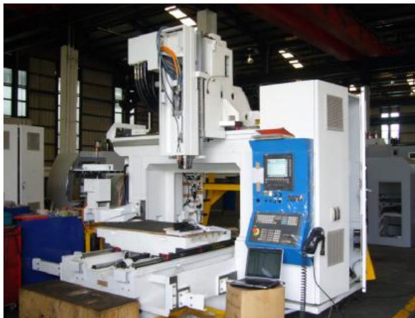
Figure 30. Photographie (en cour de montage de la MOCN d'étude)
