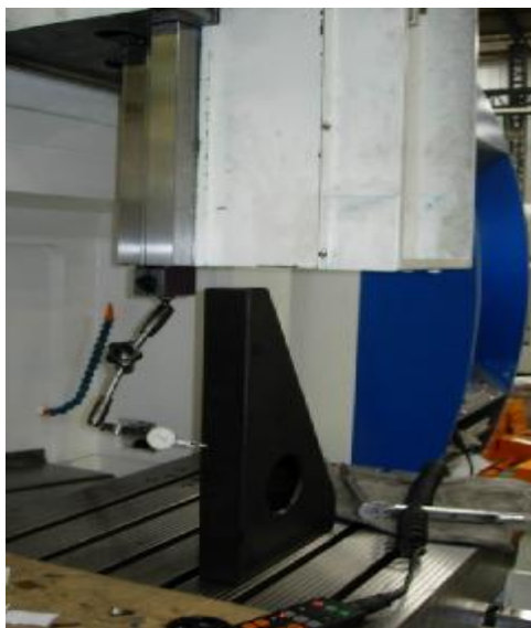
Figure 21. Contrôle géométrique suivant la norme ISO/10791-2 :2001
