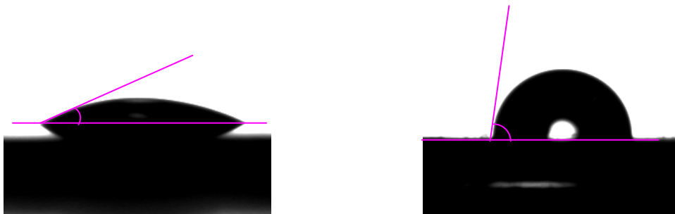
Figure 2.34 : Exemples de mesures de l'angle de contact formé entre la surface et la tangente à la goutte d'eau déposée sur la surface. A gauche l'angle proche de 20^\circ est caractéristique d'une surface hydrophile. A droite l'angle proche de 90^\circ est caractéristique d'une surface hydrophobe.
