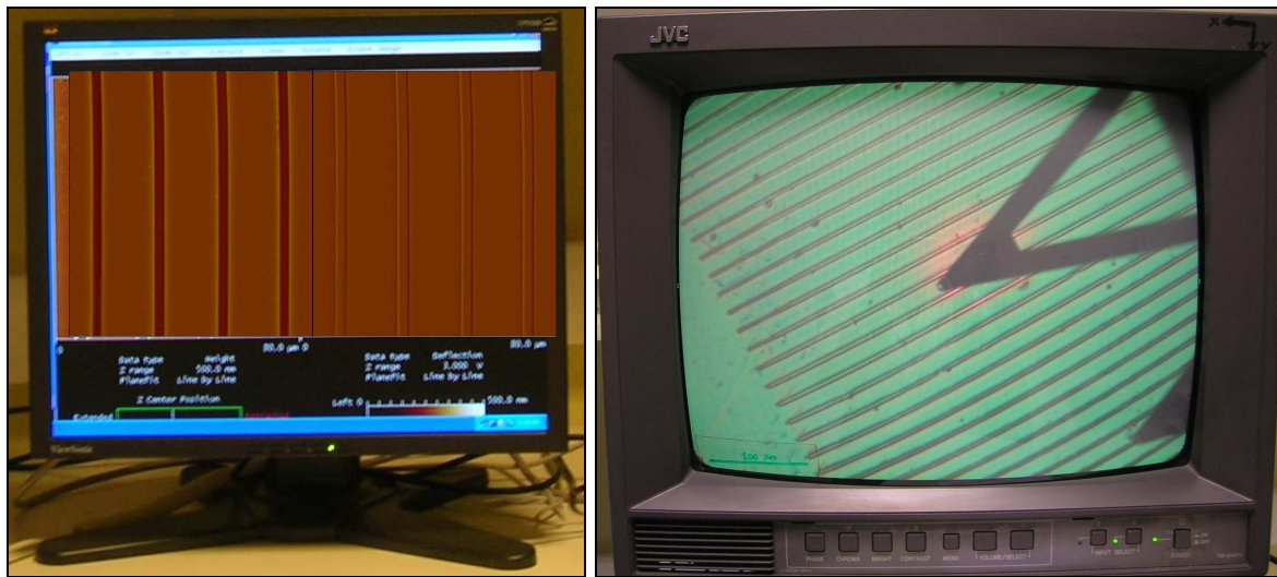
Figure 2.24 : (A) Image numérique de la topographie de surface d'un film imprimé obtenue par la technique d'AFM ; (B) image digitale de l'ensemble de la surface du film et de la pointe, visionnée sur l'écran de contrôle relié à la caméra de l'AFM.
