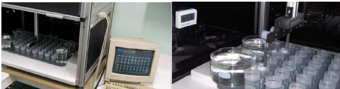
**Figure 2.4 :** Système automatisé de trempage ou Dipping robot pour la construction des films multicouches.
