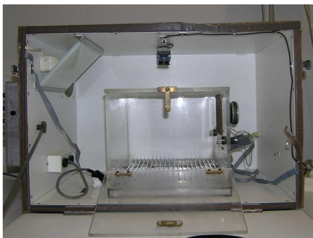
Figure 26 : Photographie d'une boîte de conditionnement
