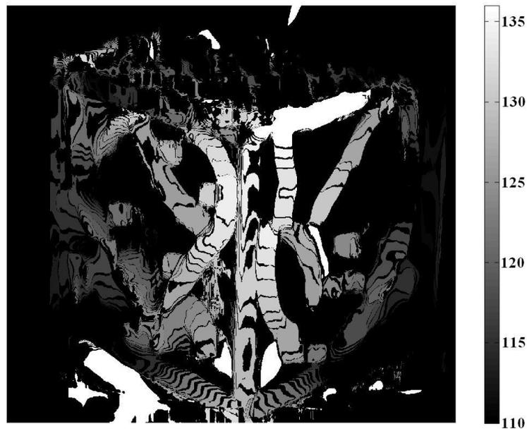
**Figure 4.14 - Carte de disparité issue de la mise en correspondance des images d'intensité multi-spectrales**
