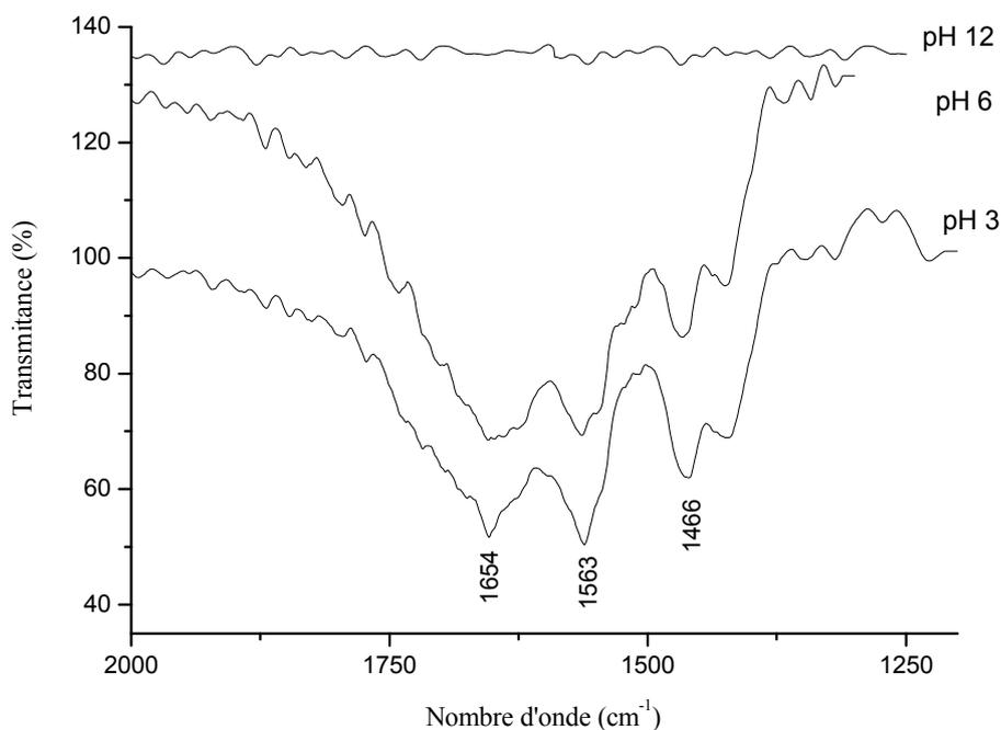
**Figure 28.** Spectre IR de  $\text{SnO}_2\text{:F}$  fonctionnalisé par l'acide acétique en fonction du pH de la solution de modification (par transmission).
