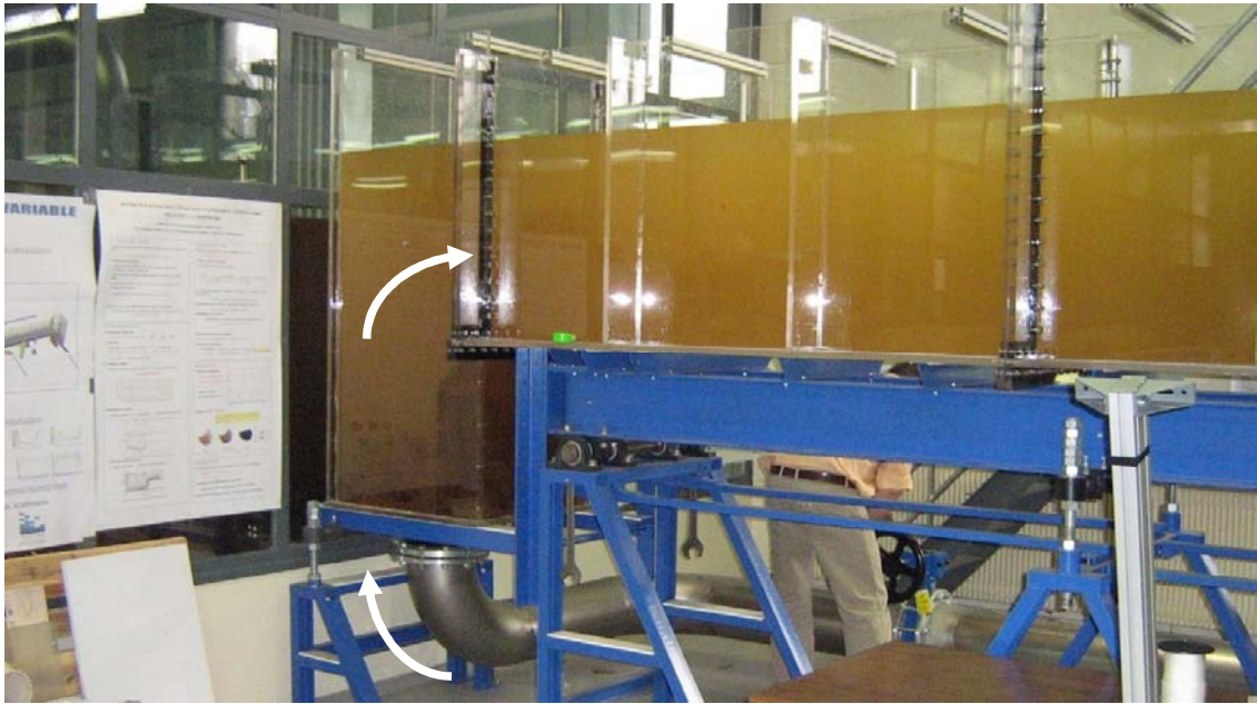
Figure 8-3 Alimentation par débordement du canal
