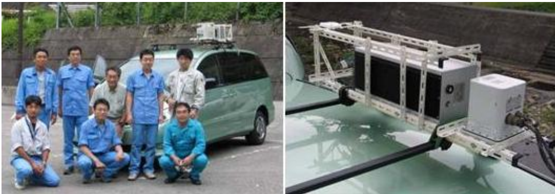
Figure 6.14 Scanner LMS-Q560, à retour d'onde complet, embarqué sur le véhicule Fallbeispiel MLS am Auto.
