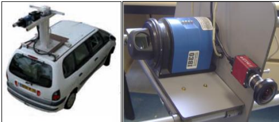
Figure 2.1 Véhicule LaRA aménagé pour des relevés mobiles (à gauche) et télémètre laser couplé avec un capteur œil-de-poisson (à droit).
