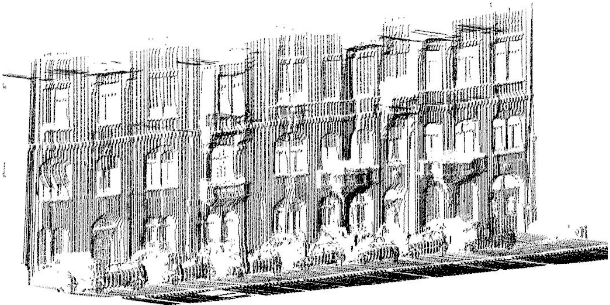
Figure 11.15 Nuage de points obtenu après correction des six éléments du trajet par la méthode photogrammétrique proposée.
