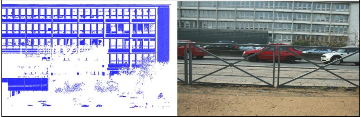
Figure 11.3 Calibration à partir d'un nuage de points dense et d'une photo
