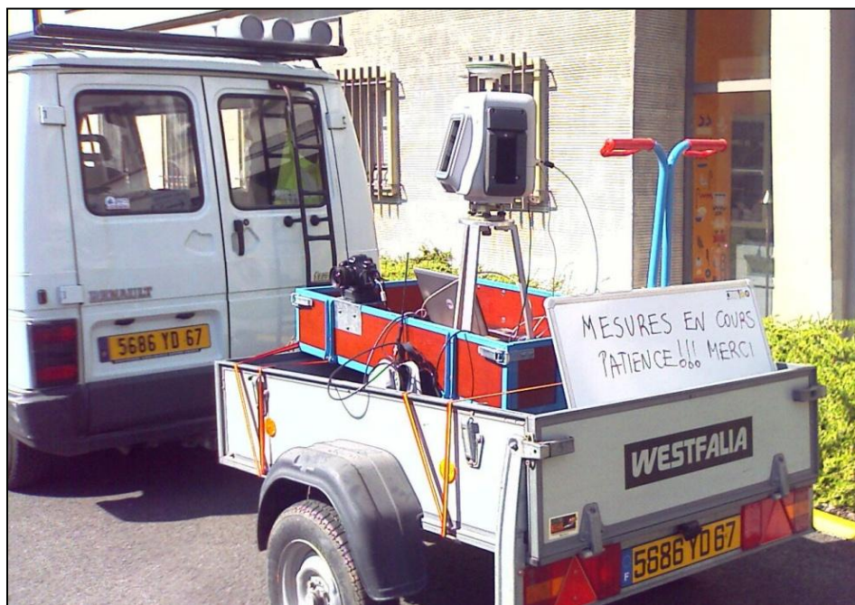
Figure 10.19 Test du système mobile après montage sur une remorque attelée à un véhicule.
