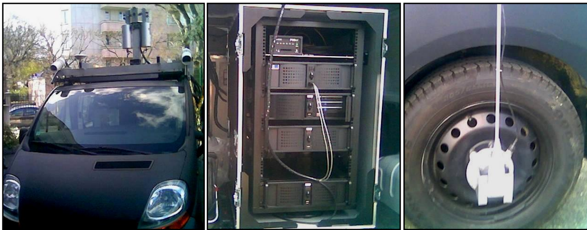
a. Figure 2.2. a : Vue générale du système Stéréopolis avec les capteurs imageurs. b : centrale inertielle et unités pilotage-stockage. c : odomètre installé sur la roue arrière gauche.
