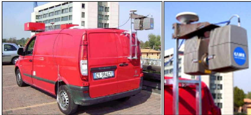
Figure 6.11 Configuration de l'angle mort du scanner vers le haut choisi par Roadscanner TM
