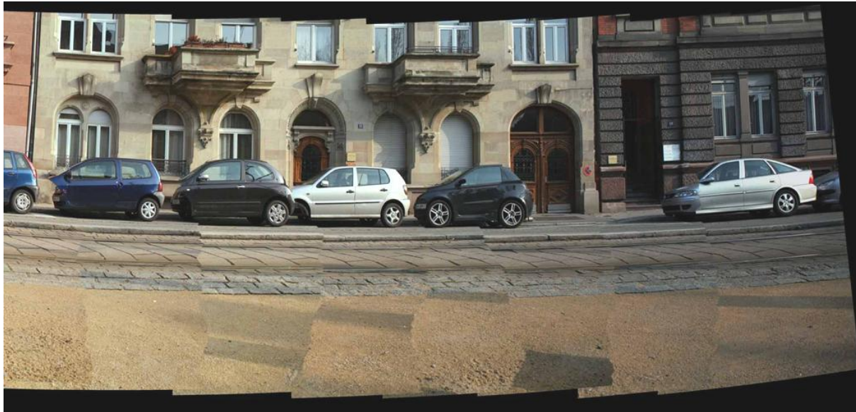
Figure 11.7 Reconstitution panoramique à partir de 8 photos acquises par l'appareil Canon EOS 5D en mode mobile (objectif 28mm)
