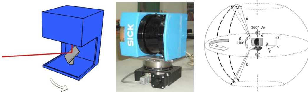
Figure 6.6 Scanner SICK-LMS 200 : le principe du miroir tournant à 2D et la migration en 3D (Zhang, 2008).
