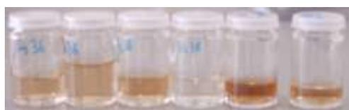
*Figure 60 : photos de quelques surnageants obtenues après des lavages par centrifugation. Ils sont colorés car ils contiennent des nanoparticules dendronisées et ne permettent pas une étude précise du taux de greffage.*
