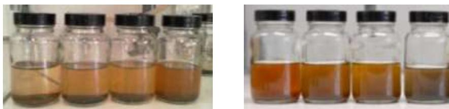
*Figure 59 : photo des suspensions obtenues, 30 minutes après la fin de la réaction de greffage, dans le THF (à gauche) et dans le dichlorométhane (à droite). La concentration initiale de dendrons est de gauche à droite de 200, 300, 400 et 500 mg/L respectivement.*
