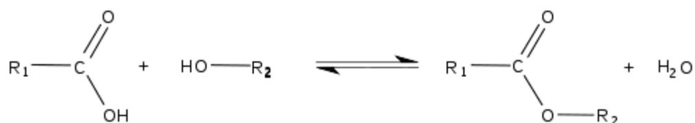
Figure 20: Schéma général d'une réaction d'estérification.
