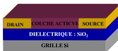
Figure 3 : Structure des transistors réalisés.
