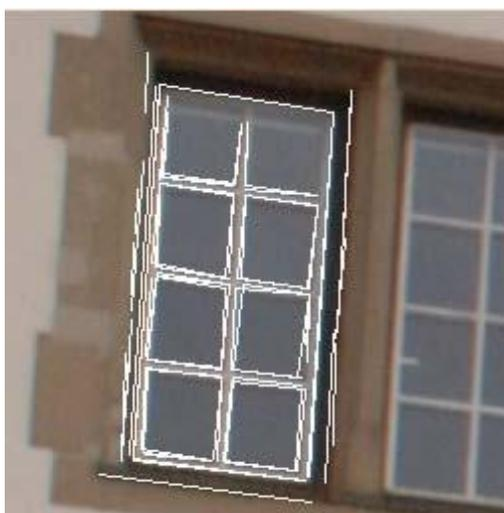
Figure 2.28. Extraction de contours sur les images pour améliorer le niveau de modélisation des fenêtres (Böhm *et al.*, 2007).
