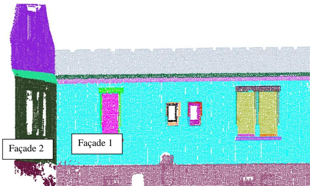
Figure 5.8. Exemple de résultat fourni par une segmentation semi-automatique de façade (seuils fixés à 1.5 cm pour la façade 1 et à 4 cm pour la façade 2)
