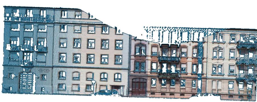
Figure 3.6. Résultat de la suppression manuelle des points indésirables du nuage de points brut de la Figure 3.4 (à l'aide du logiciel RealWorks de Trimble)
