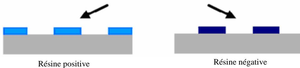
**Figure 54 : Développement de la résine**
