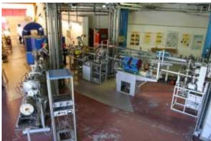
*Figure A.1* Accélérateur de particules pour applications RBS et ERDA.
