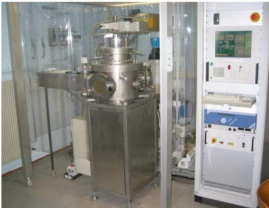
Figure 3.3 Photo du réacteur PECVD (à gauche) et de sa console de commande (à droite).
