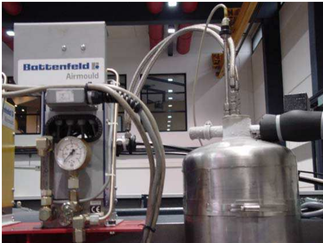
Figure 23: Bonbonne cryogénique installée sur presse à coté d'une électrovanne (document Battenfeld)
