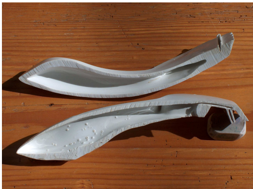
Figure 18b: Coupe longitudinale avec visualisation d'un amas matière important sur la pièce du haut
