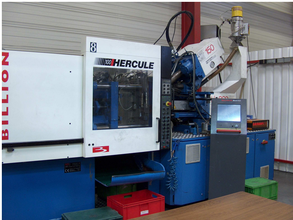
Figure 3: Presse bi-matière Billion modèle Hercule 100 t (10 kN) de force de fermeture
