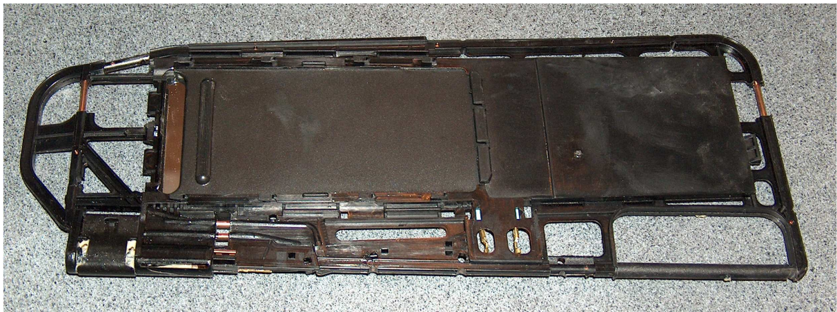
Figure 73: Insert avec renfort de fil métallique
