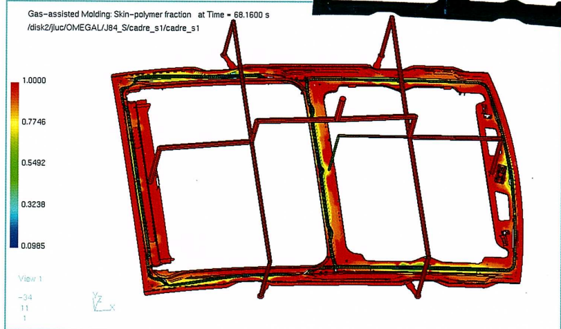
Cadre de toit ouvrant, moule comprenant 7 buses chaudes et 10 injecteurs gaz
