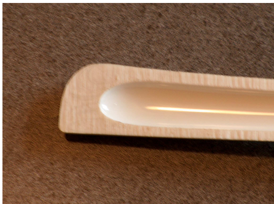
Figure 27: Phase de remplissage Forme arrondie du front de gaz
