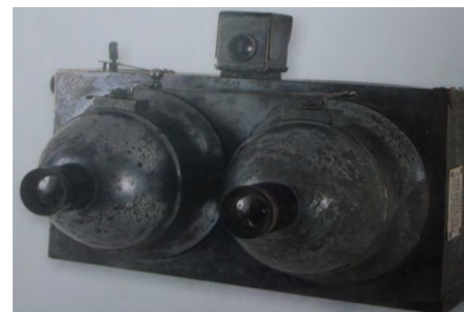
Photosphère stéréoscopique, 1892, viseur amovible à tiroir, plaques négatives de 9 x 18 cm, diaf. 13, f. 95 mm
